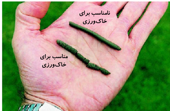
شکل ۵-۹- آزمایش مزرعه‌ای خاک برای تعیین زمان مناسب برای خاک‌ورزی.
